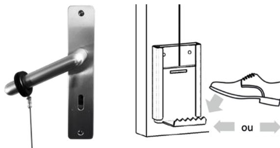
Ouverture de la porte : appuyer sur la pédale avec le pied, Tirer ou pousser simultanément
