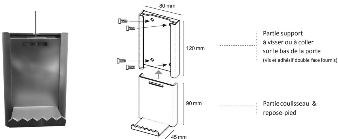
La fixation du support au bas de la porte doit se faire en veillant à garder la poignée en position fermée (horizontale = pas de tension dans le câble)
